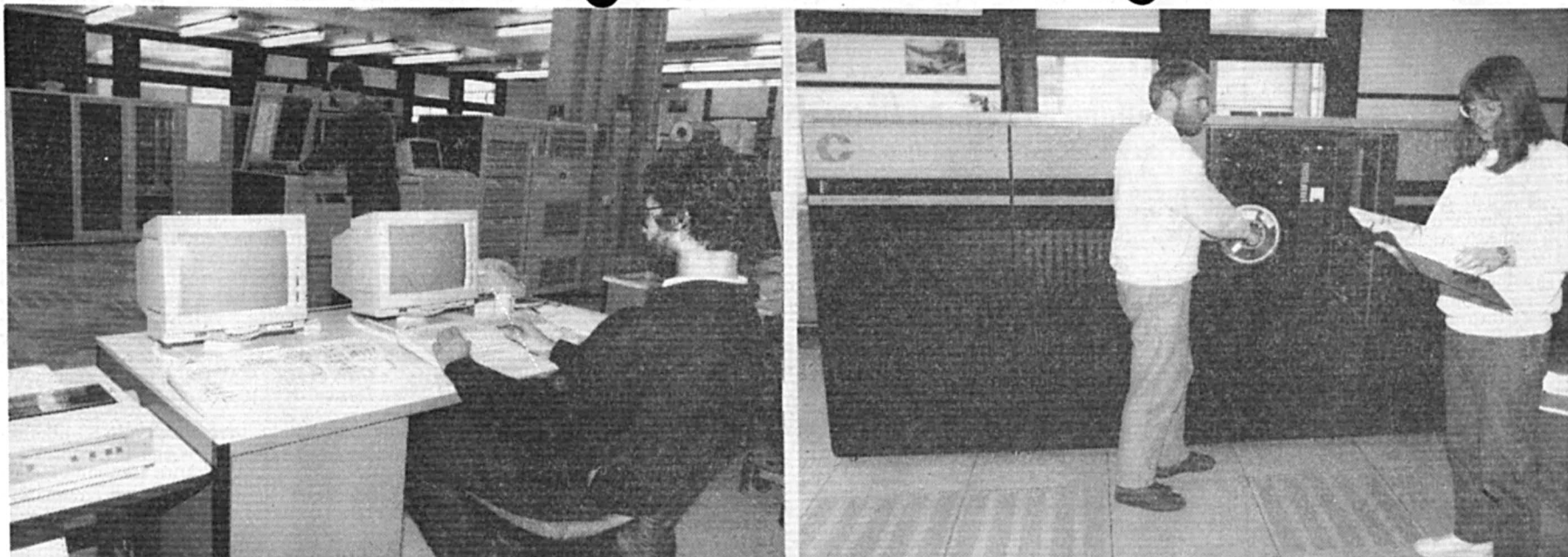
Neue Rechner im Hochschulrechenzentrum der Philipps-Universität: links im Bild die neue VAX 6000-420, die als zweiter zentraler Rechner betrie-
