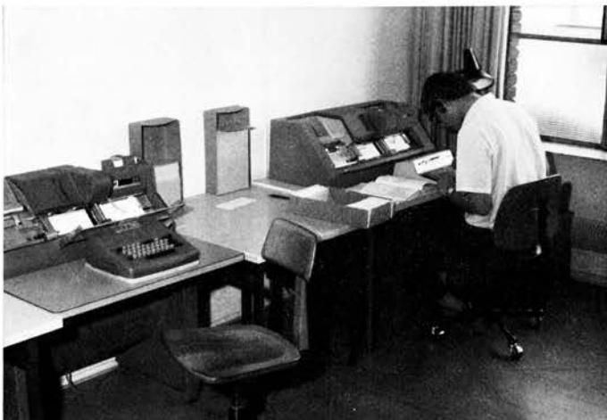
Abb. 6: Ein Benutzer locht sein Programm für den TR4 auf einem Schreiblocher IBM 029 ab.
