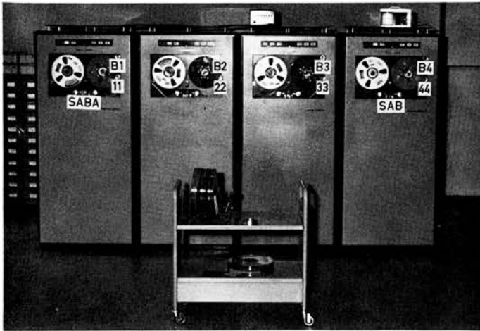
Abb. 2: Die vier Magnetbandgeräte dienen zur Zwischenspeicherung von Informationen.
