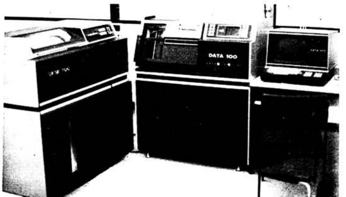
Abb. 9: Datenstation DATA 100 zum Verkehr mit dem Hochschulrechenzentrum Darmstadt.
